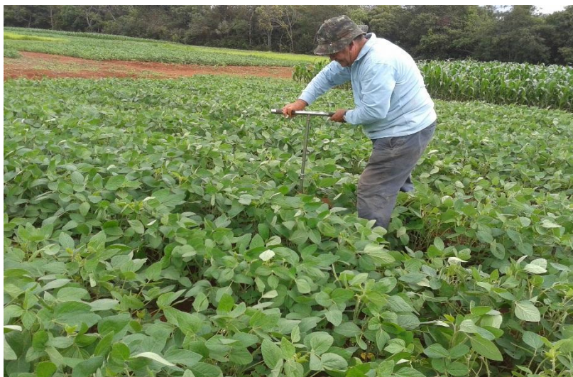
Figura 4. Coleta de amostras do solo
