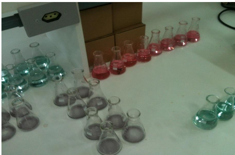
Figura 7. Erlenmeyers com os padrões de cores característicos de cada etapa, antes e após a titulação para quantificação de nitrogênio mineral do solo
