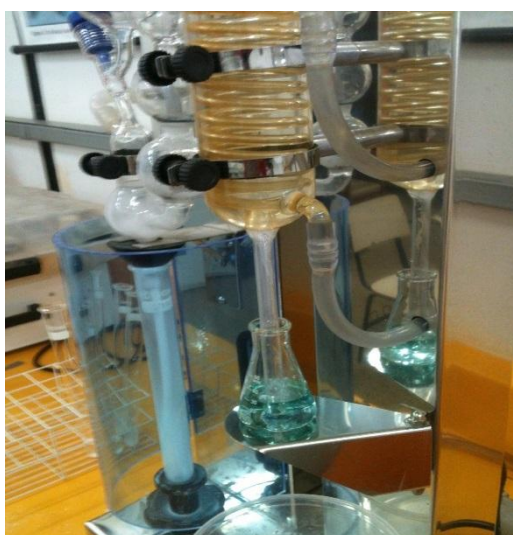
Figura 6. Destilador utilizado na quantificação de nitrogênio
