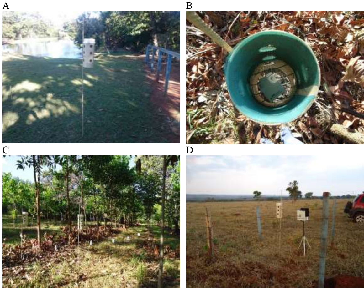
Figura 5. Abrigos para coleta de dados micrometeorológicos: (A) visão geral do abrigo; (B) visão interna do abrigo, com telado e o coletor de dados HOBO; (C) coletores de dados na área de acácia; (D) coletor de dados e estação WatchDog na área de pastagem. Fotos tiradas entre junho e novembro de 2015, Cristianópolis, GO.
