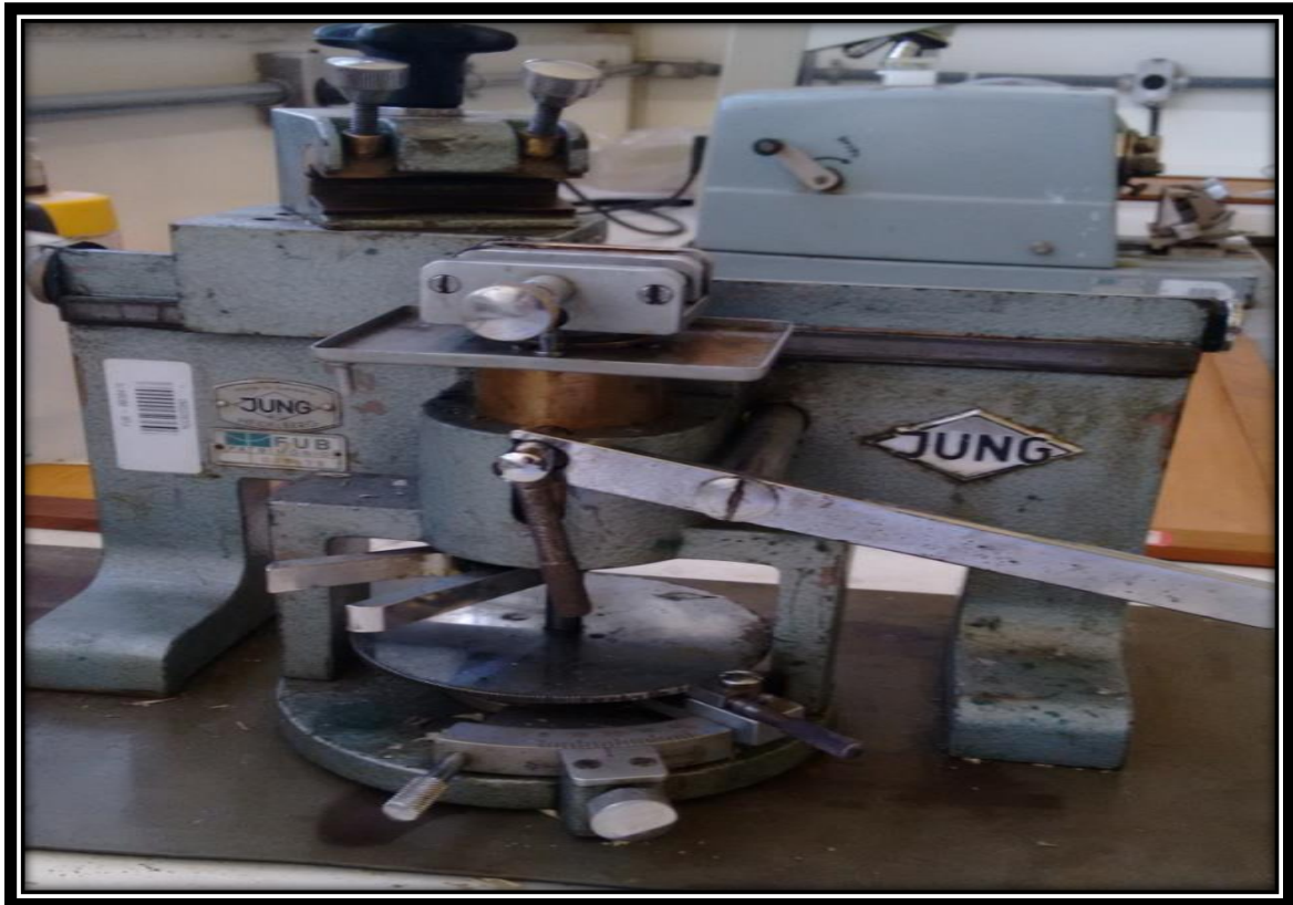
Figura 8. Micrótopo de deslize (Marca Jung), para madeira, utilizado no estudo. (Laboratório de espectrometria, Gel documentação e microtomia / Unb).
