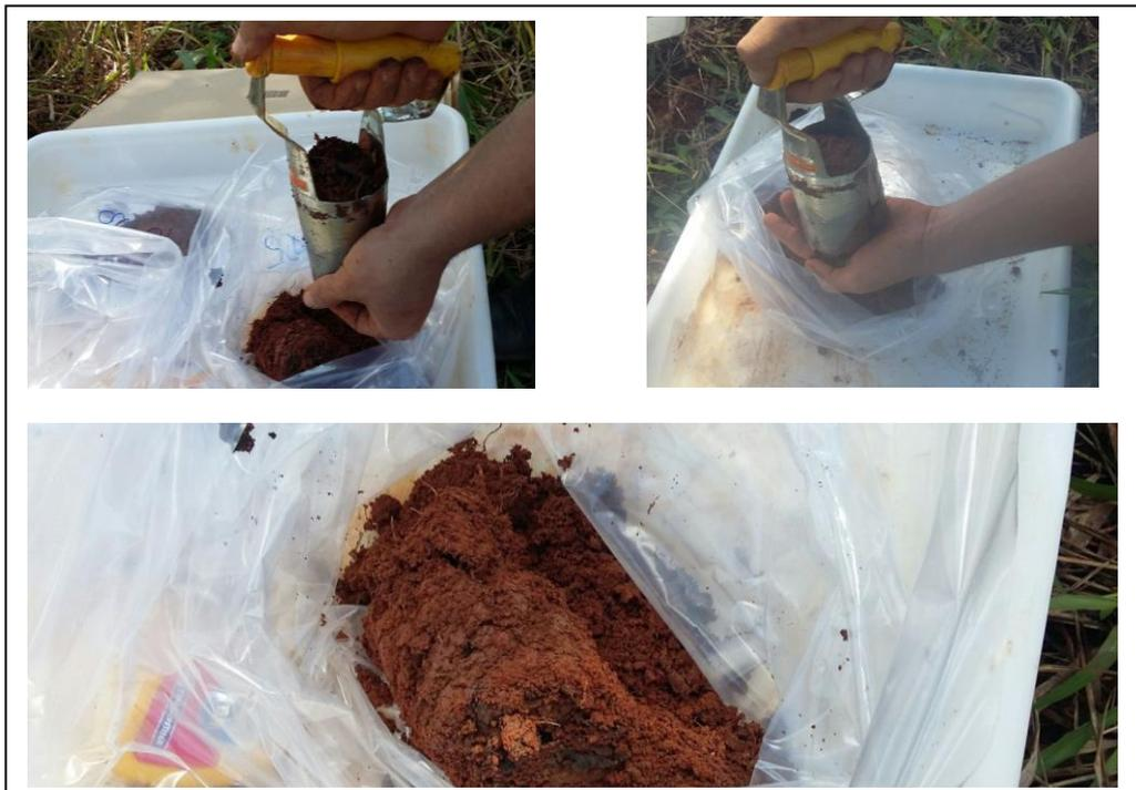
**Figura 8.** Coleta dos monólitos de solo para posterior análise de estabilidade de agregados e análise química e biológica.
