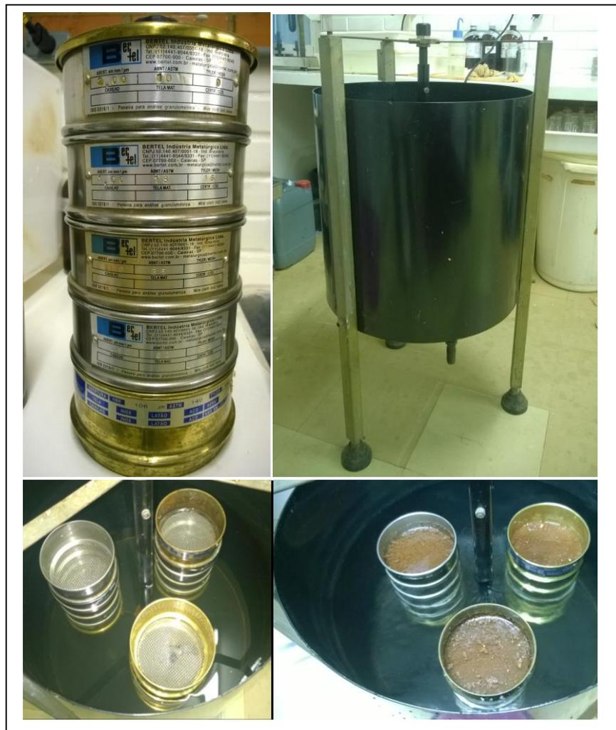
**Figura 9.** Conjunto de peneiras e equipamento Yoder usados para análise de estabilidade de agregados.
