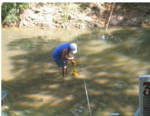
**Figura 16: Molinete Hidrométrico.**
