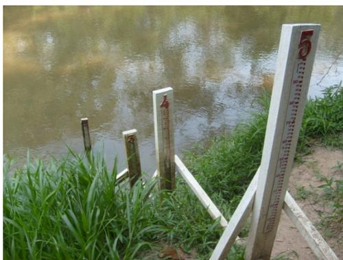
**Figura 17: Réguas Fluviométricas.**
