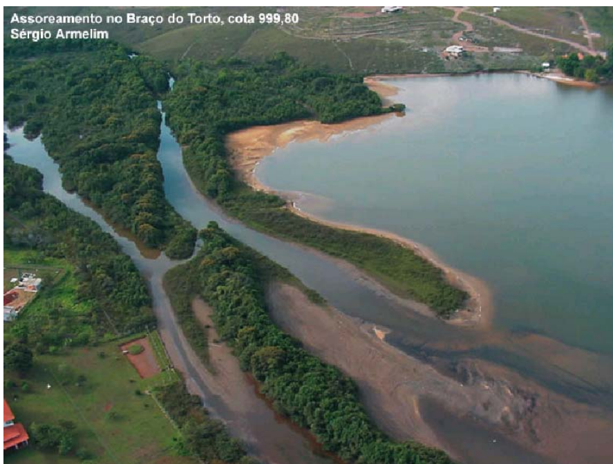
Figura 20. Exemplo de área assoreada no Braço do Torto. Fonte: Sérgio Armelino
