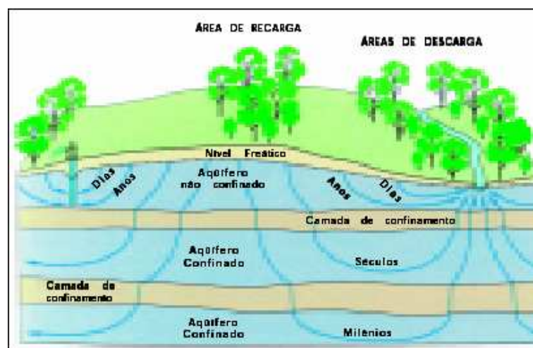
Figura 08 – Fluxo de recarga e descarga de águas subterrâneas
