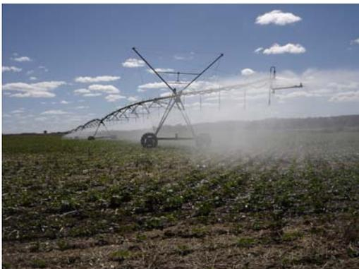
**Foto 43** – Pivô-central em funcionamento (Ponto 14).
