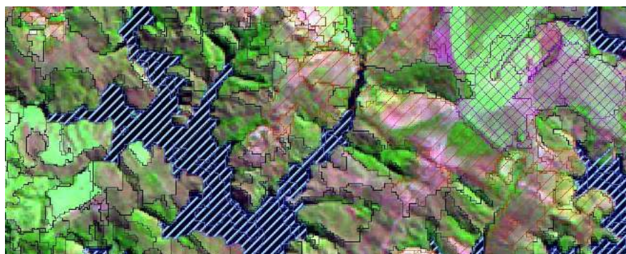
Figura 14 – Cena Landsat 220/71 do ano de 1990 inspecionada em fluxo contrário (da mais recente para a mais antiga) utilizando hachuras para indicar os usos. Linhas espessas foram utilizadas em massa d'água, enquanto linhas delgadas foram sobrepostas aos polígonos de uso para permitir a visualização da imagem abaixo.
